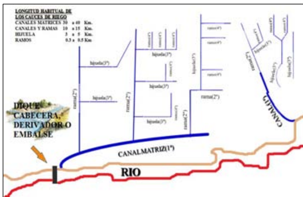
Figura 1.- Sistema de distribución del agua para riego superficial en Mendoza (Luraschi, 2007)
