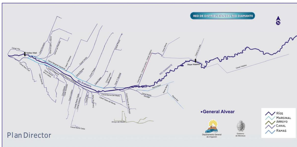
Gráfico 8: Red de Distribución del Río Diamante. Fuente: Departamento General de Irrigación. Gobierno de Mendoza
