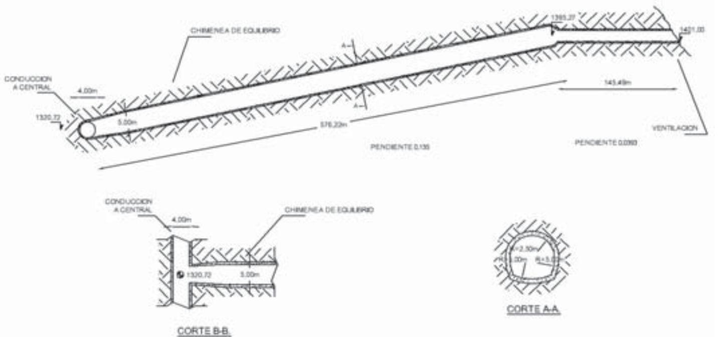
PLANTA Y CORTE ESQUEMATICO DE LA DARSENA DE RESTITUCION DE CENTRAL CACHEUTA DEL COMPLEJO POTRERILLOS - CACHEUTA
