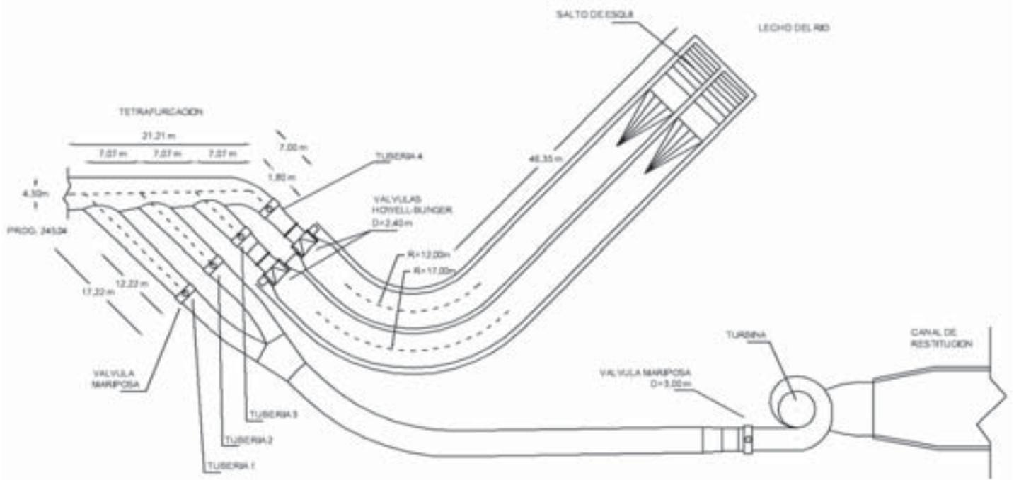
PLANTA Y CORTE ESQUEMATICO DE LA DERIVACION PARA RIEGO DEL COMPLEJO NIHUIL IV
