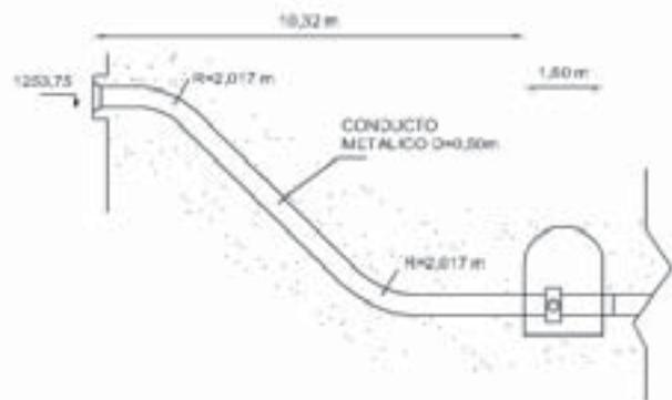
**CORTE ESQUEMATICO DE LOS DESCARGADORES DE MATERIALES SOLIDOS EN SUSPENSION DEL COMPLEJO AGUA DEL TORO**
