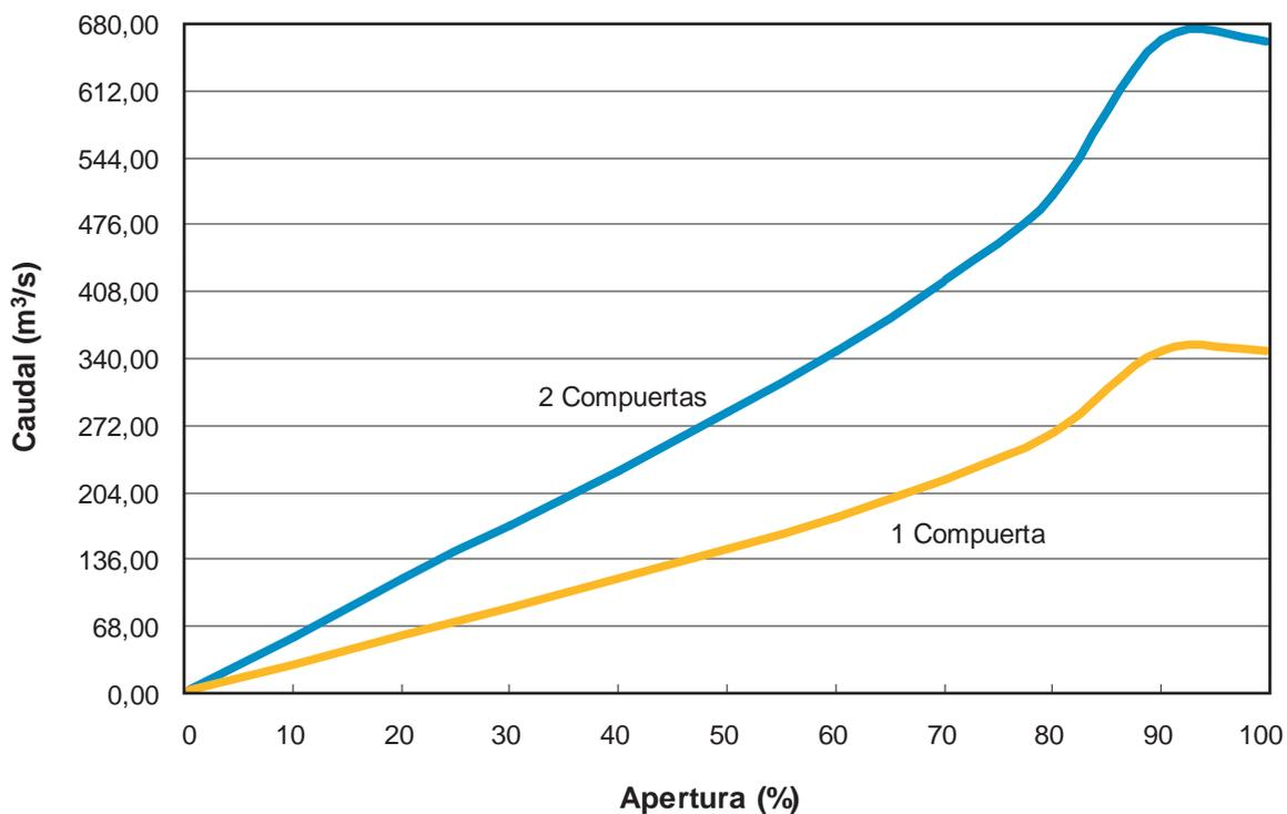
**Curva de erogación por válvula de chorro hueco para descargador de fondo a cota 1362,00 m.s.n.m. Presa Potrerillos.**
