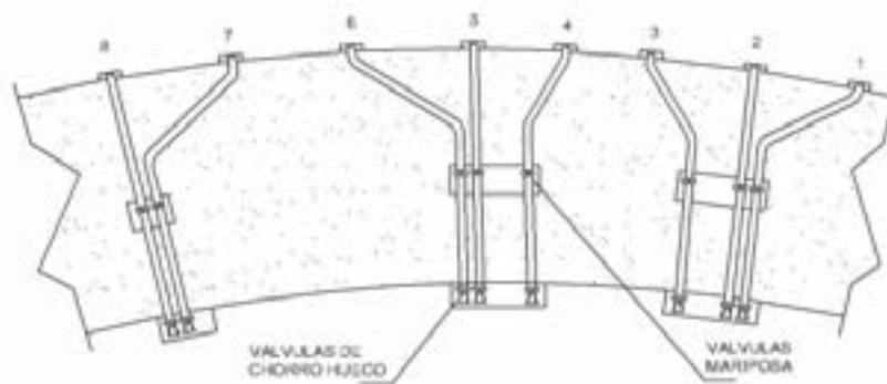
CORTE ESQUEMATICO DE LOS DESCARGADORES 3 Y 4.
