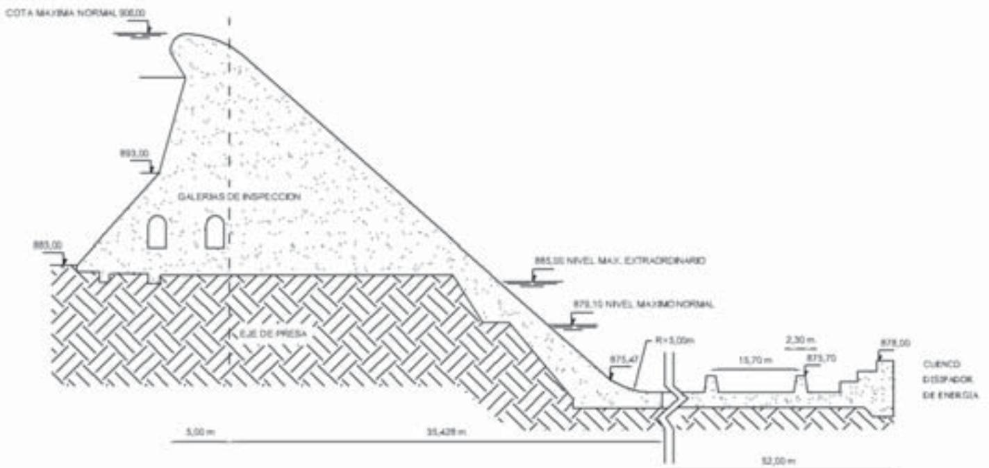
CORTE ESQUEMATICO DE LA DESCARGA PARA RIEGO DEL COMPLEJO EL TIGRE
