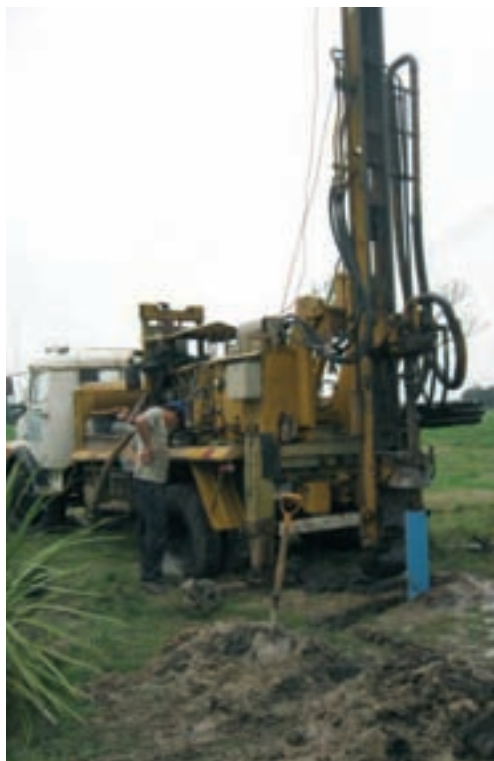
Fig. 17. Máquina perforadora. Método de rotopercusión
