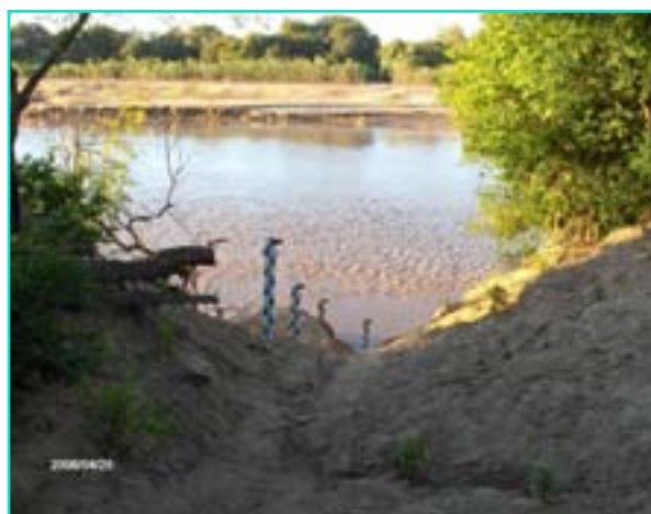
Figura 21 Escalas hidrométricas. Permite medir los niveles que alcanza el agua en una sección del río y estimar el caudal en ese tramo del curso de agua.
