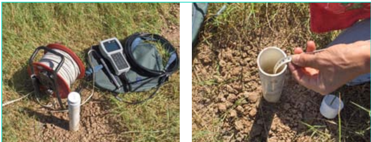
Figura 18 Medición de la profundidad del nivel de agua subterránea
