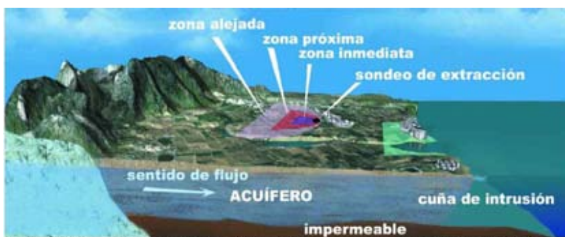
Esquema que representa las diferentes zonas de protección de la calidad del agua subterránea en un pozo destinado al abastecimiento urbano
