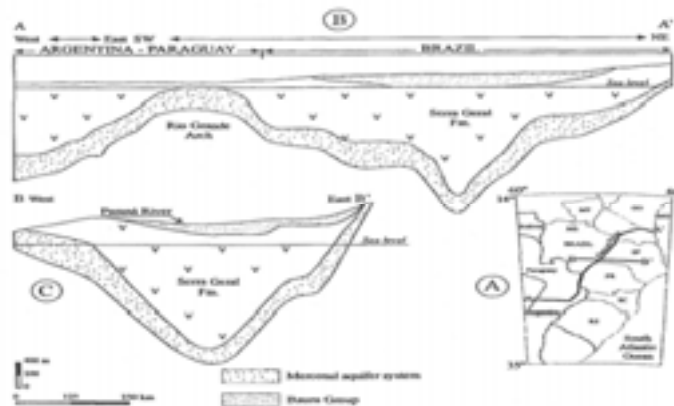
Fig. 13 - SECCIONES ESTRUCTURALES REGIONALES A TRAVÉS DEL SAG
